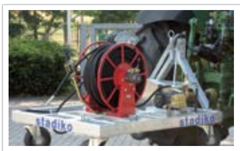
stadiko® HD 42/150 myjka HD z trzy punktowym wejściem na płukanie drenażu
