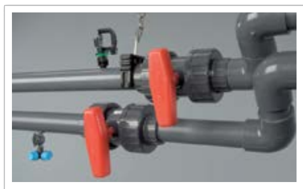
Połączona swobodnie wibrująca instalacja rozmiękczająca i chłodząca. Łatwe blokowanie i zwalnianie przewodów zraszających i natryskowych za pośrednictwem zaworów kulowych. Wedle wyboru sterowanie może następować za pośrednictwem zaworów magnetycznych.
